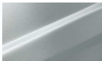
Silber natur E6/EV1 Eloxal, Detailelemente pulverbeschichtet RAL 9006
